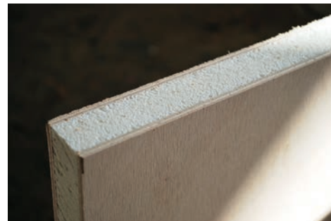
detail PUR výplně dveří
